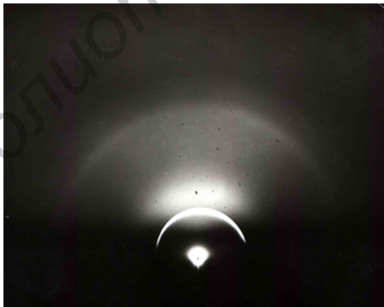
Рисунок 25 – Электроннограмма, свидетельствующая о том, что на поверхности имеется тонкий поликристаллический слой
