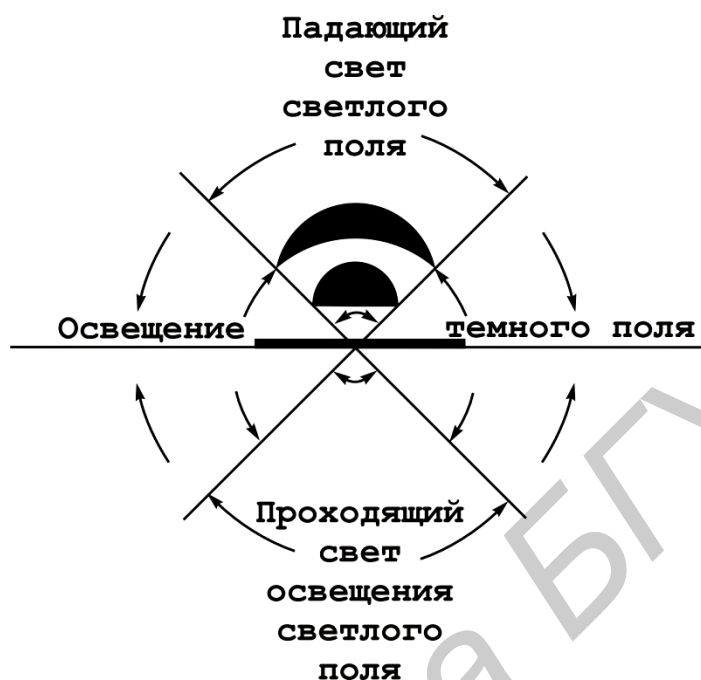
Рисунок 13 – Границы освещения по методу светлого и темного полей
