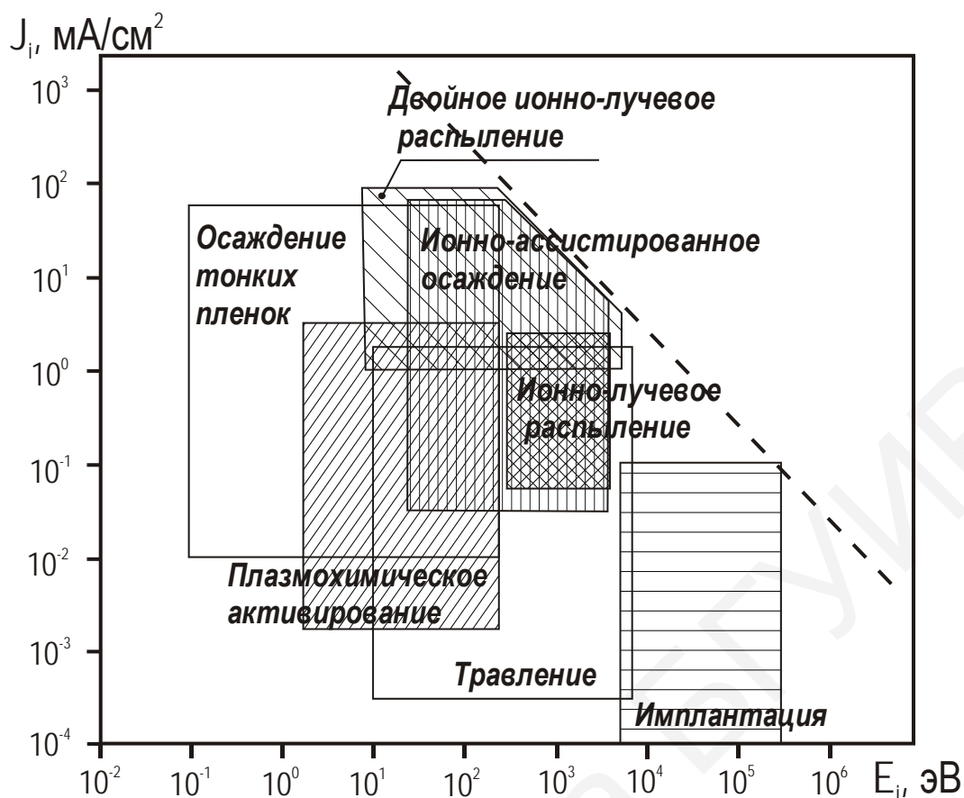
Рисунок 26 – Сравнительная диаграмма диапазонов энергий и эквивалентных плотностей тока для различных ионно-лучевых и ионно-плазменных процессов
