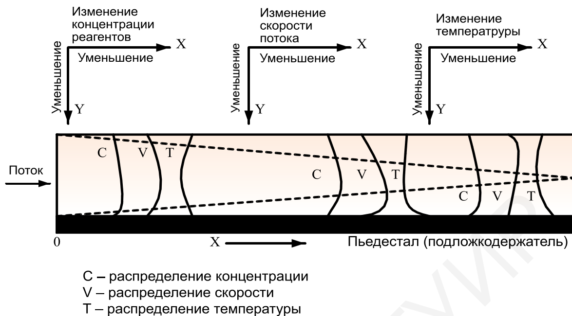
Рисунок 2 – Формирование пограничного слоя (слоя Гельмгольца) у стенок реактора
