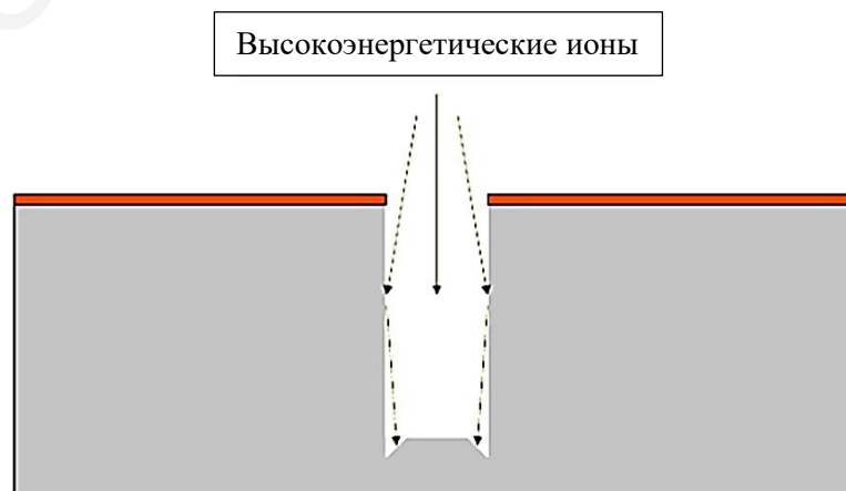
Рисунок 33 – Профиль структуры, обусловленный отражением ионов от стенок
