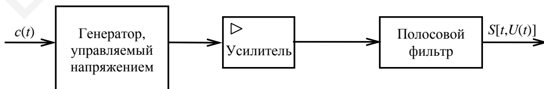
Рисунок 4.24 – Функциональная схема устройства формирования ЧМП-сигнала с непрерывной фазой
