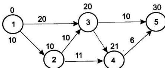
Рис. 7.3. Оптимальный сетевой график
