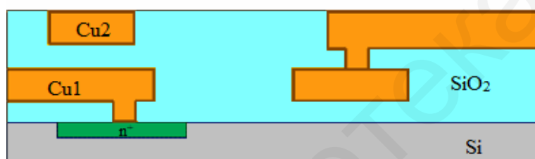
Рисунок 22 – Последовательность формирования двухуровневой металлизации на основе пленок меди, осажденной электрохимическим методом
