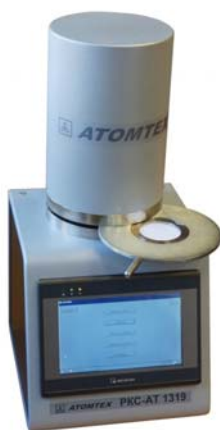
Внешний вид альфа-бета-радиометра РКС-АТ1319
