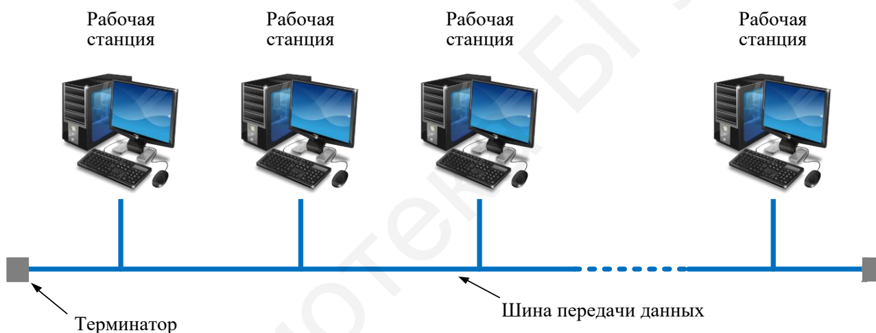
Рис. 1.2. Топология сети типа «общая шина»
