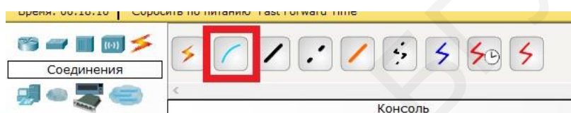
Рис. 3.3. Выбор консольного подключения на вкладке «Соединения»
