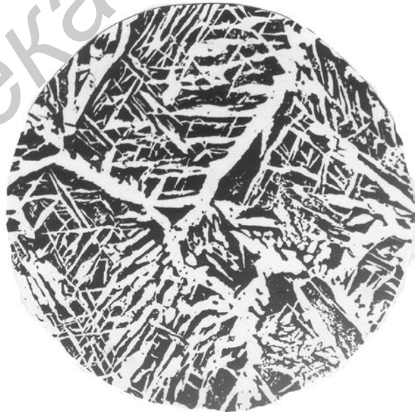
Рис. П.8. Микроструктура доэвтектоидной стали: перлит и феррит пластинчатого строения
