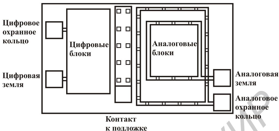
Рис. 1.15. Пример компоновки на кристалле цифровых и аналоговых блоков
