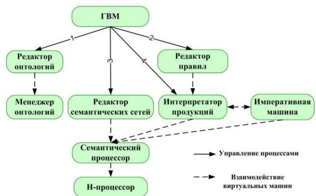
Рисунок 5 – Система виртуальных машин оболочки СОЗ традиционного типа
