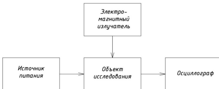
Рис.1 Структурная схема комплекса для проведения исследования
