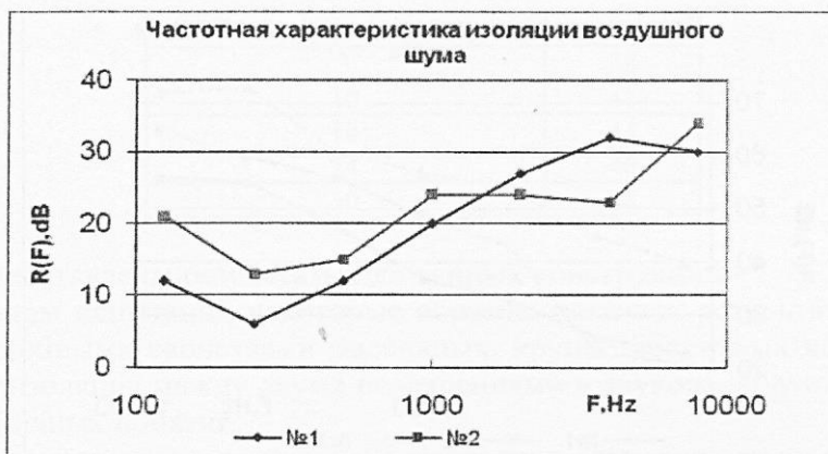
Рис. 6. Частотная характеристика изоляции воздушного шума: №1 — лист сотового поликарбоната 10 мм; №2 — два листа сотового поликарбоната 20 мм; №3 — лист оргстекла толщиной 8 мм
