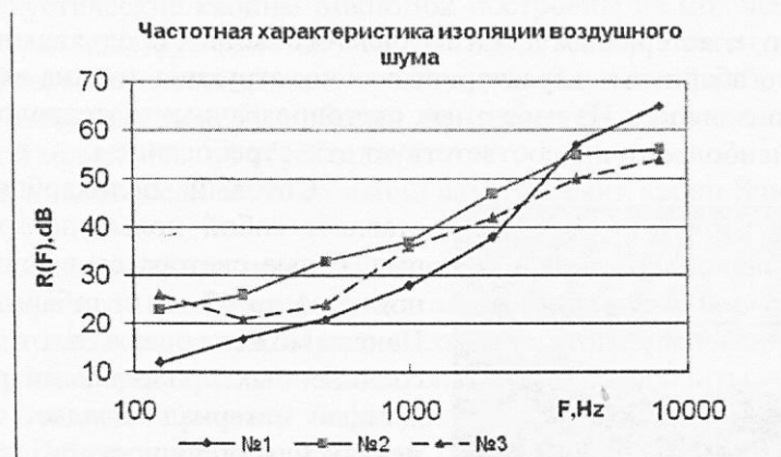
Рис. 5. Частотная характеристика изоляции воздушного шума: №1 — стеклопакет из оргстекла заполненный воздухом; №2 — стеклопакет из оргстекла заполненный водой
