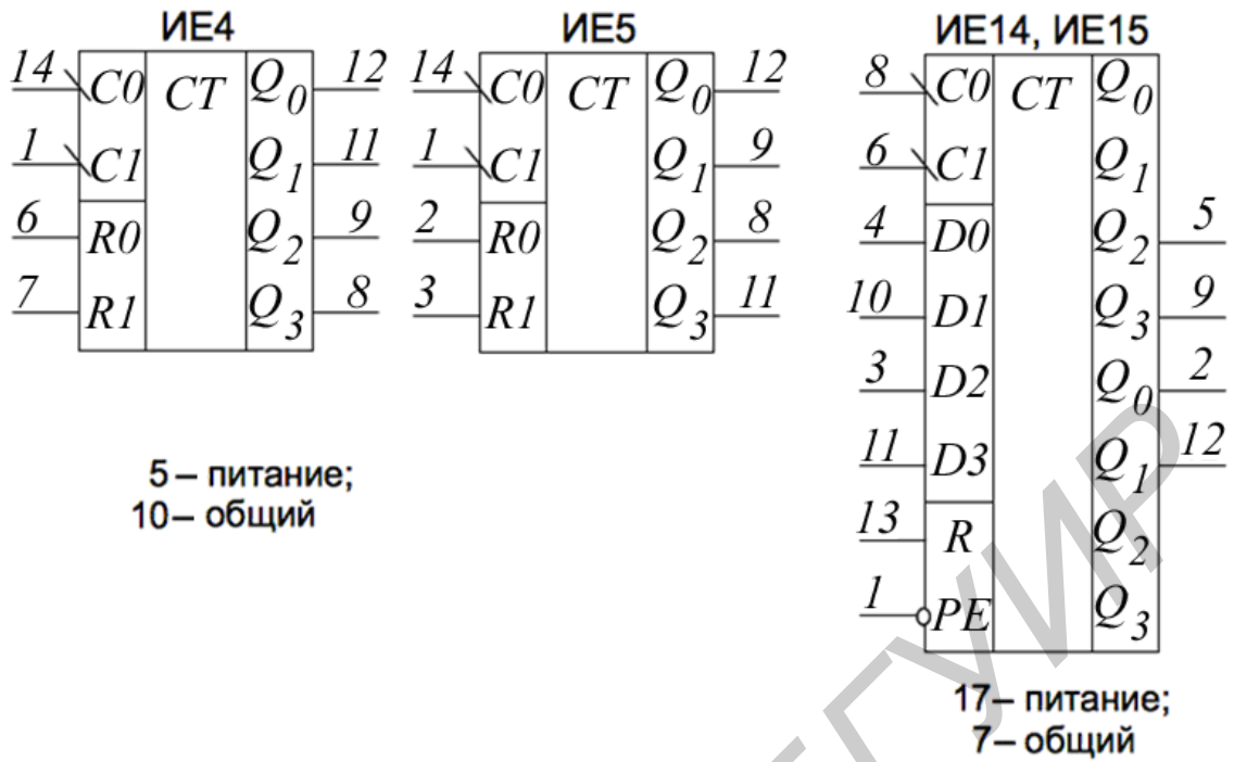
Рис. 9.10. Условные обозначения ИС ИЕ4, ИЕ5, ИЕ14, ИЕ15
