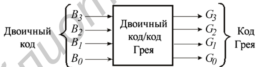
Рис. 4.1. Блок-диаграмма преобразователя двоичного кода в код Грея
