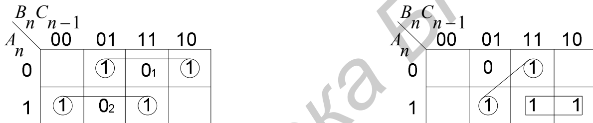
Рис. 3.3. Упрощение выражений для S_n и C_n полного сумматора
