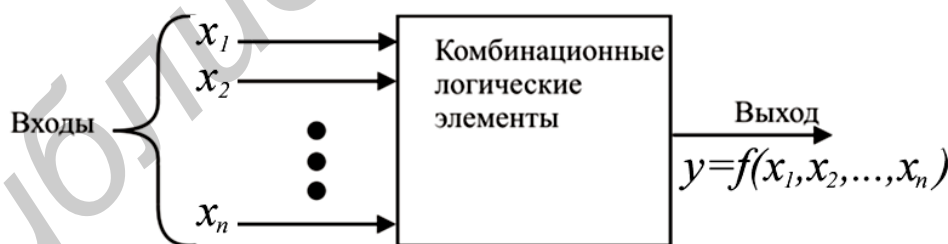
Рис. 1.1. Блок-схема комбинационного устройства
