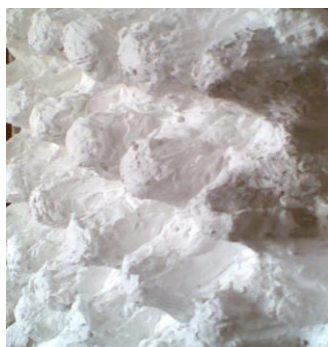
Рисунок 5. – Внешний вид исследуемого образца поглотителя ЭМИ с геометрическими неоднородностями поверхности
