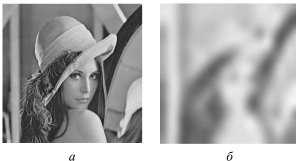
Рис. 3. Результат работы алгоритма формирования изображений низкого пространственного разрешения: a – исходное изображение высокого разрешения; b – изображение низкого пространственного разрешения
