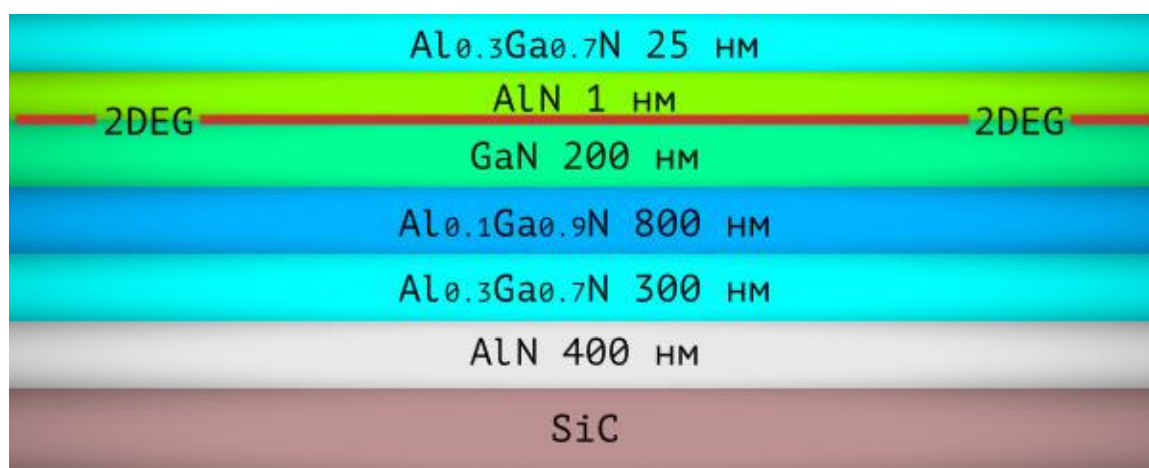
Рисунок 2 – Дизайн гетероструктуры на подложке из карбида кремния
