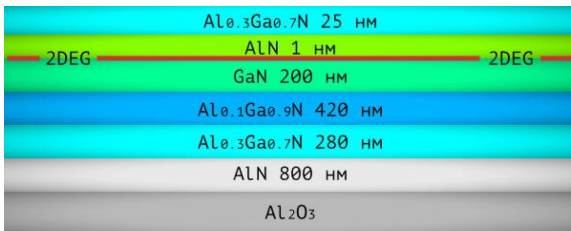
Рисунок 1 – Дизайн гетероструктуры на подложке из сапфира
