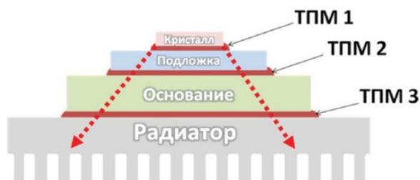
Рисунок 2 – Распределение тепла и основные теплопроводящие уровни
