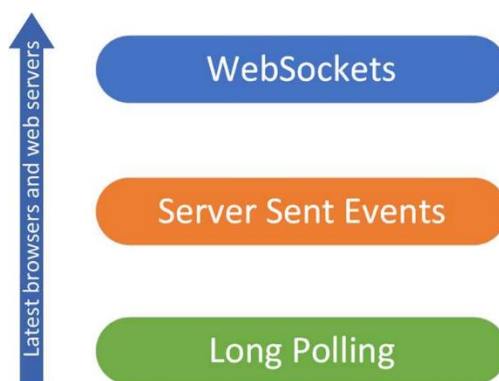
Рисунок 2 – Схема транспортов SignalR
