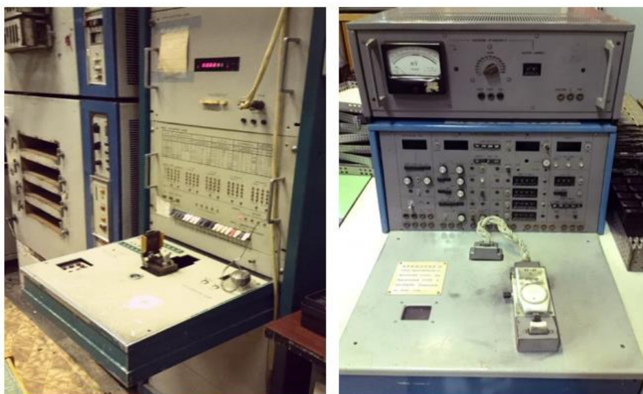
Рисунок 1 – Установки для измерения параметров полупроводниковых приборов
