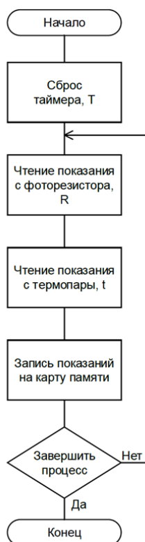
Рисунок 5 – Схема алгоритма работы автоматизированного контроля
