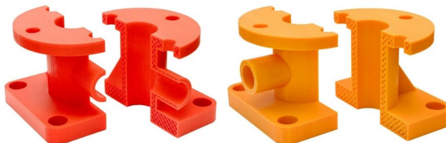
Рисунок 2 – Учебная модель корпуса, распечатанного на 3D-принтере
