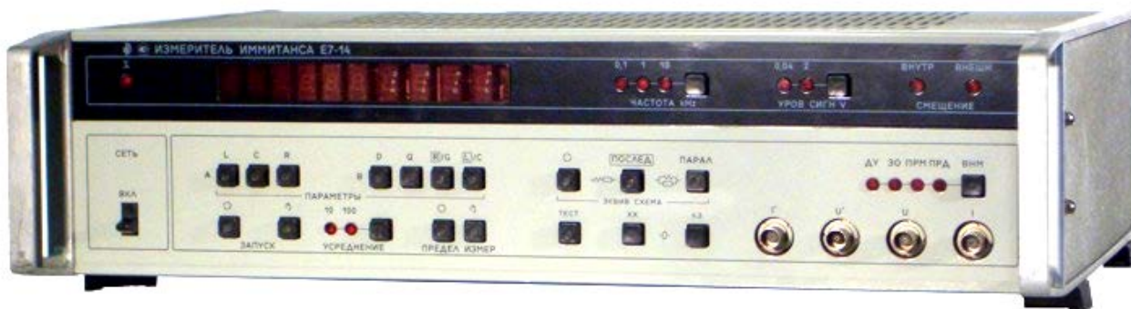
Рисунок Ж.1 – Внешний вид измерителя иммитанса Е7-14
