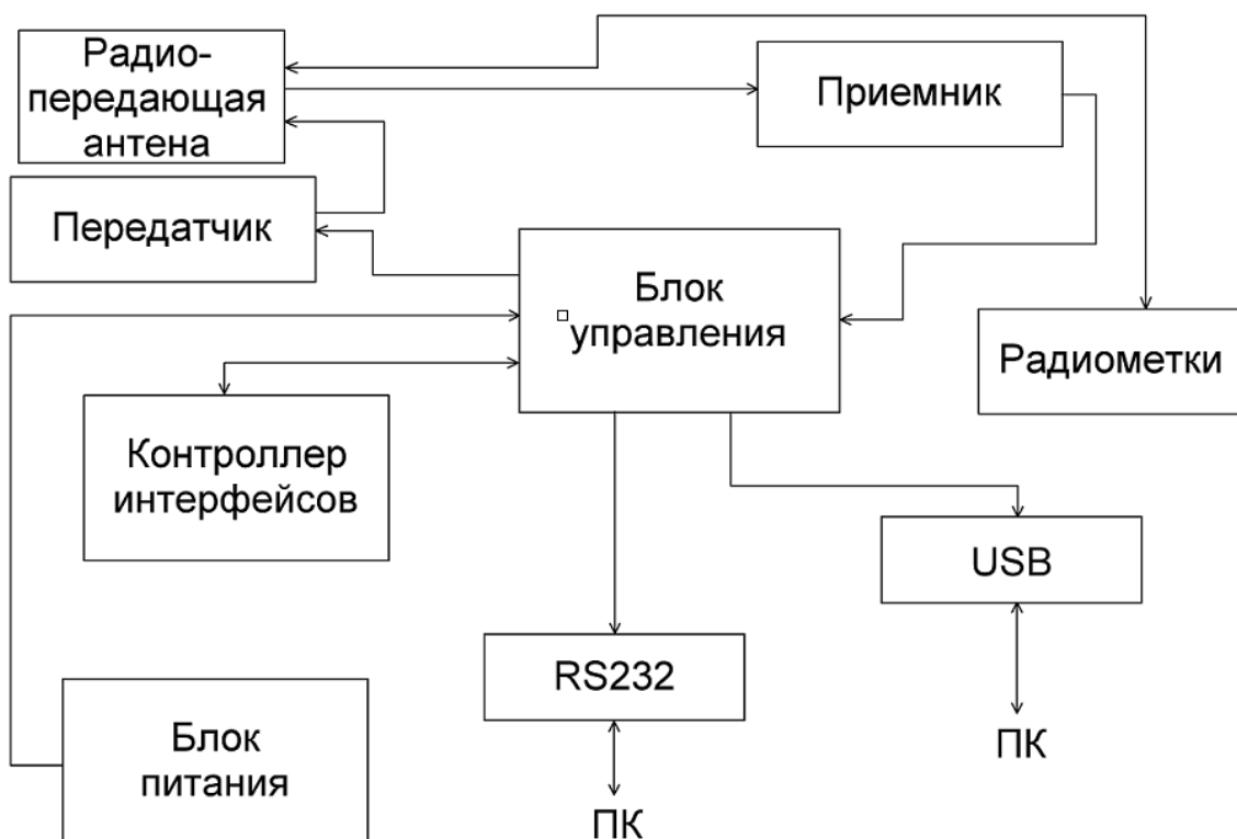
Рисунок 1 – Схема электрическая структурная разработанной системы
