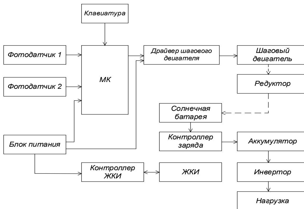
Рисунок 1 – Структурная схема системы позиционирования солнечной батареи на основе микроконтроллера
