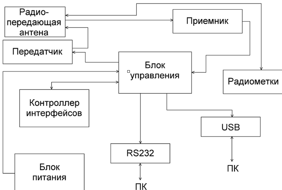
Рисунок 1 – Схема электрическая структурная разработанной системы
