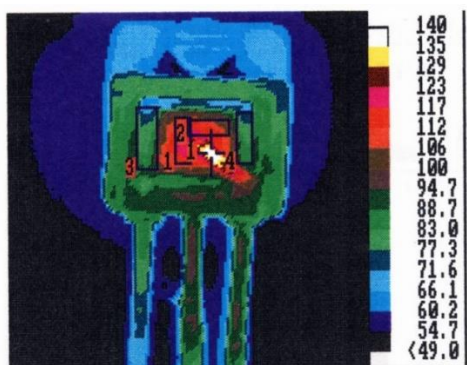
Рисунок 2 – Термограмма распределения температур на МОП транзисторе, включенном с радиатором
