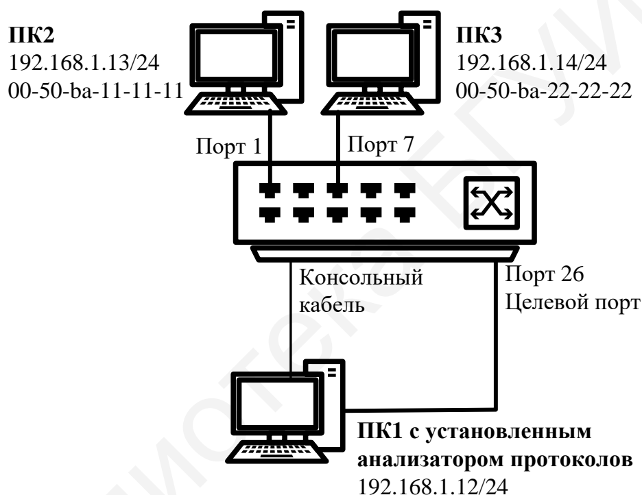
Рис. 7.4. Схема подключения для настройки фильтрации кадров
