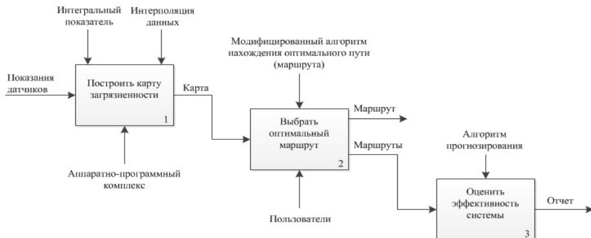
Рис. 3. Структура предложенной системы поддержки принятия решений при выборе оптимального маршрута с учетом загрязненности воздуха
