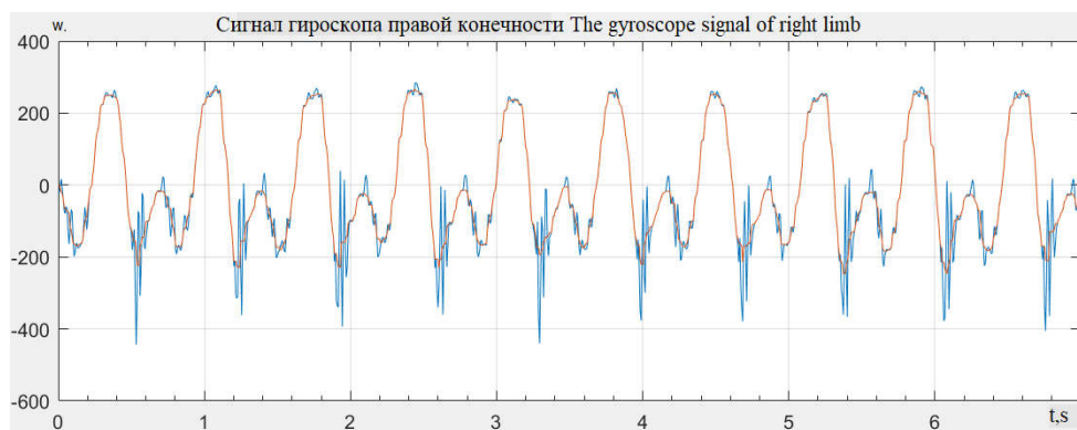
Рис. 3. Сигналы гироскопа для бега с применением адаптивного скользящего усредняющего фильтра
