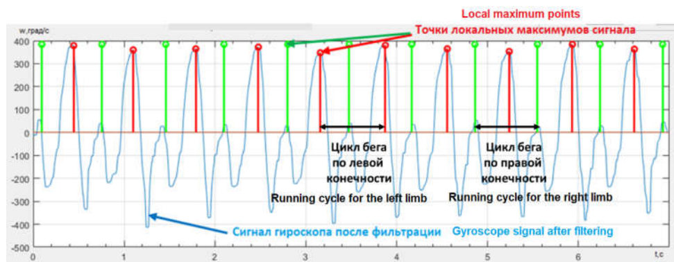
Рис. 4. Выделение циклов бега Fig. 4. Running cycle detection
