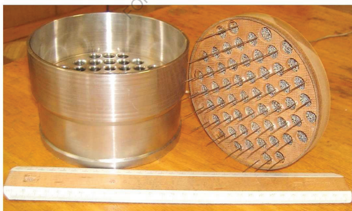
Рисунок 3.5 – Схема опытного образца аэрозольного электростатического фильтра
