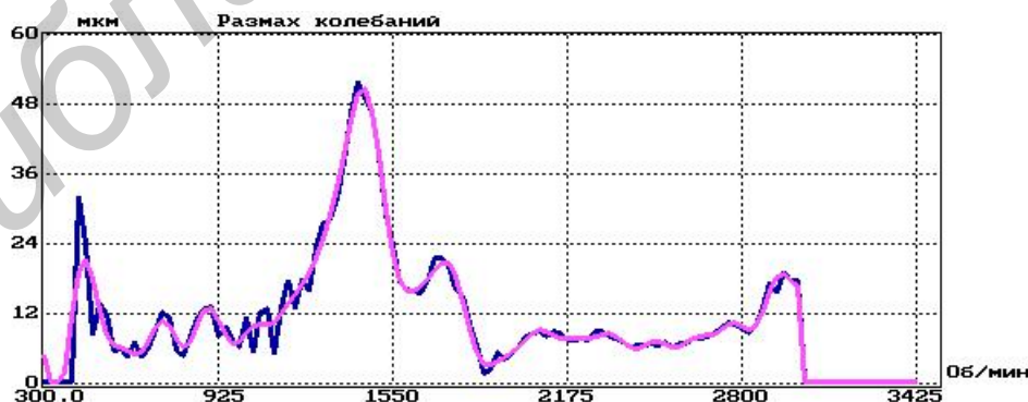
Рис. 5. Аппроксимация вибрационной характеристики выбега
