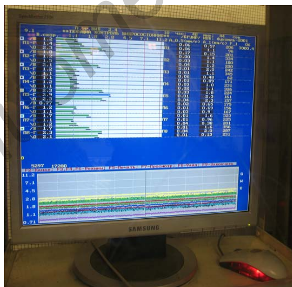
Рис. 1 Представление результатов вибрационного контроля турбоагрегата в ИВК серии «Лукомль»
