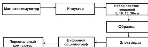
Рис. 1 Структурная схема установки для измерений влияния импульсного магнитного поля на образцы
