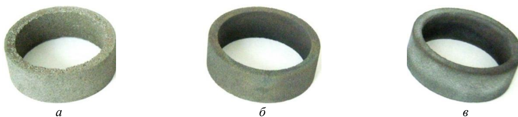
Рис. 4. Внешний вид спеченных пористых образцов до и после обработки: a – вид образца без обработки поверхности; б – вид образца с модифицированным слоем Ti(HPO_4)_2 \cdot H_2O ; в – вид поверхности образца со слоем TiO_2 после химического оксидирования
