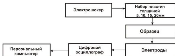
Рис. 2 Структурная схема установки для измерений влияния электрошоковых разрядов на образцы
