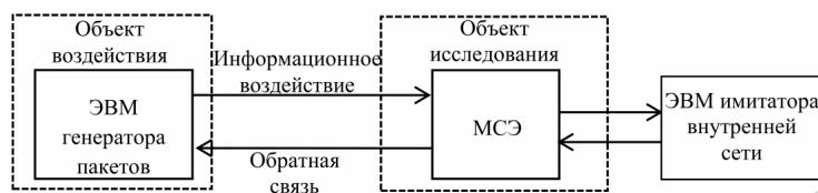
Рис. 3. Схема полунатурной модели ИТС
