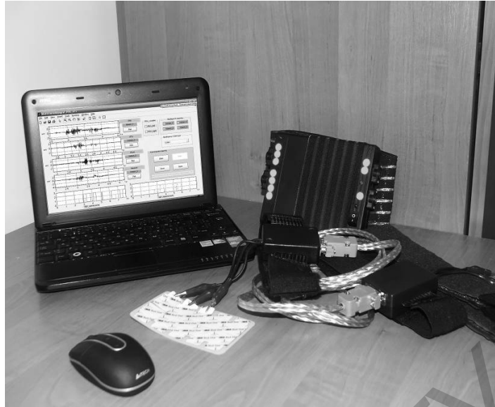
Рис. 4. Аппаратно-программный комплекс для исследования движений человека «МиоСпорт»
