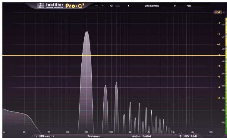
Рис. 4. Спектр синусоидального сигнала, обработанного с помощью CLA-76
