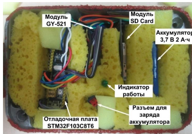
Рис. 3. Внешний вид устройства регистрации параметров движения механических объектов (со снятой верхней крышкой)
