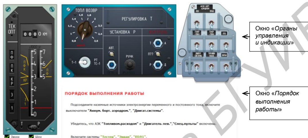
Рисунок – Визуальная часть процедурного тренажера
