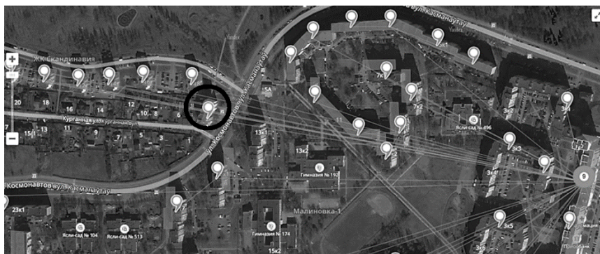
Рис.1 Смоделированная ситуация потери связи по протоколу snmp с узлом дома по ул. Космонавтов 2. Основная причина – сбой в работе электропитания коммутатора, необходимы дополнительные диагностические мероприятия
