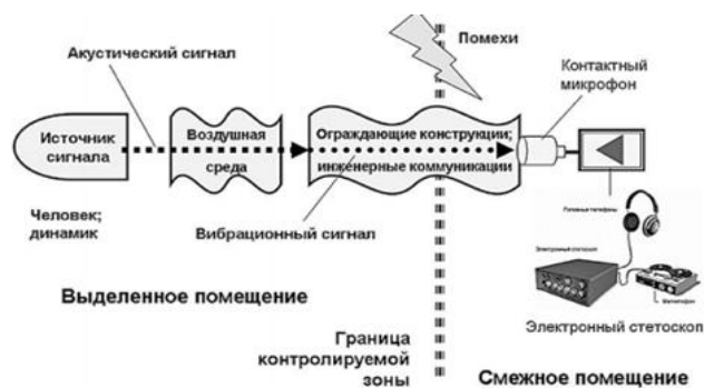
Рис. 5 - Схема виброакустического канала утечки информации
