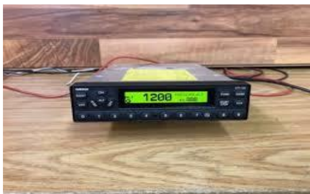
Рис.1- Изображение самолетного ответчика Garmin gtx 330
