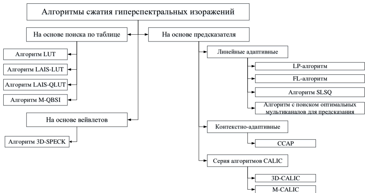
Рисунок 1. – Классификация алгоритмов сжатия гиперспектральных изображений
