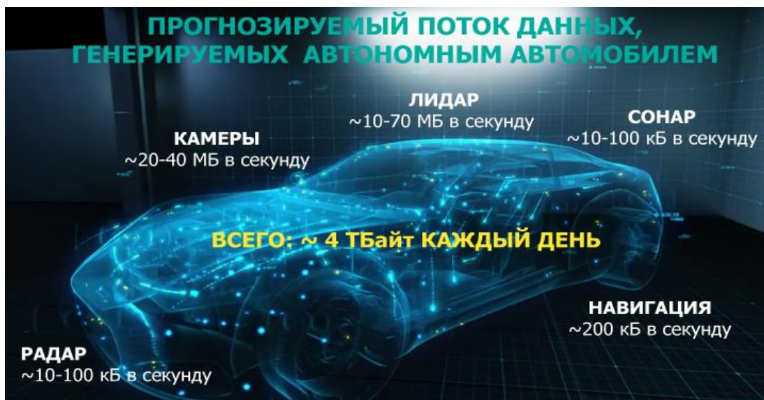
Рисунок 2. –Прогнозируемый поток данных генерируемых автономным автомобилем.
