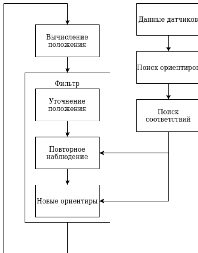
Рисунок 2. – Схема алгоритма SLAM
