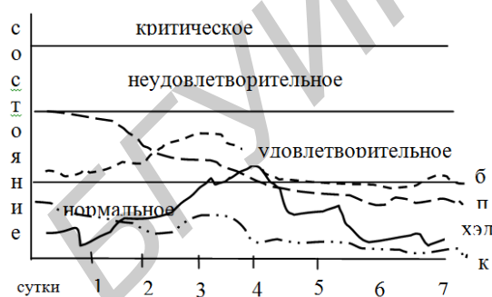
Рисунок 3 - Диаграмма оперативного диагностирования МА-Коборга
