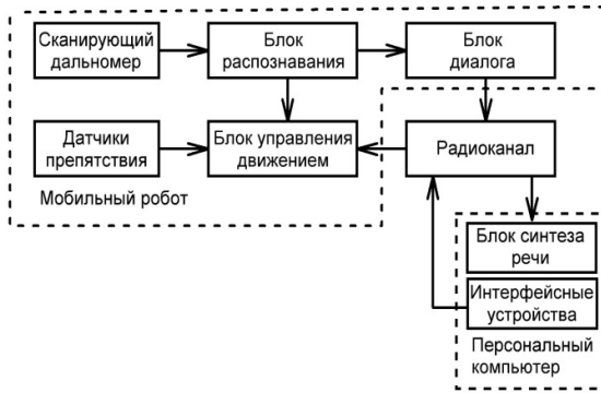
Рисунок 2 – Блок-схема системы управления автономного мобильного робота
