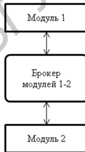
Рисунок 2 – Интеграция с использованием брокеров
