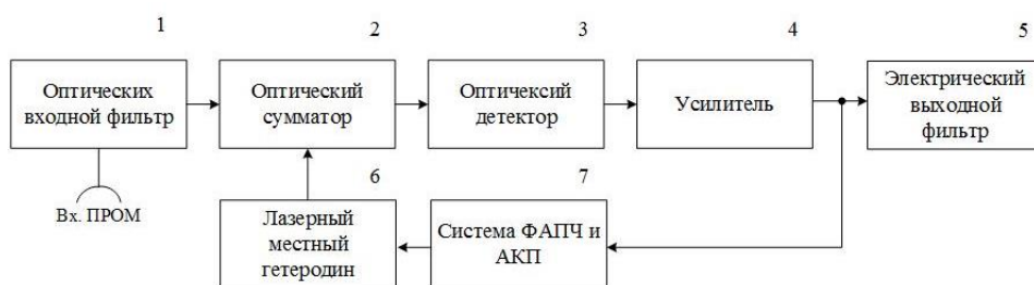
Рис. 3. Структурная схема оптического гомодинного приемника
