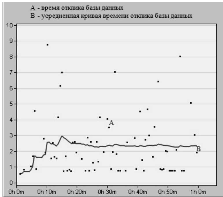
Рис. 1. График отклика баз данных без использования брандмауэра
