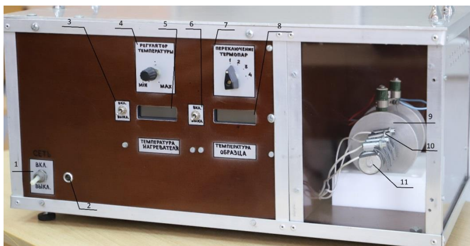
1 - тумблер сети; 2 - индикатор сети; 3 - тумблер включения индикатора нагревателя; 4 - регулятор температуры; 5 - индикатор температуры нагревателя; 6 - тумблер включения индикатора температуры образца; 7 - переключатель термопар; 8 - индикатор температуры образца в разных точках; 9 - муфель; 10 - термопары; 11 - образец
