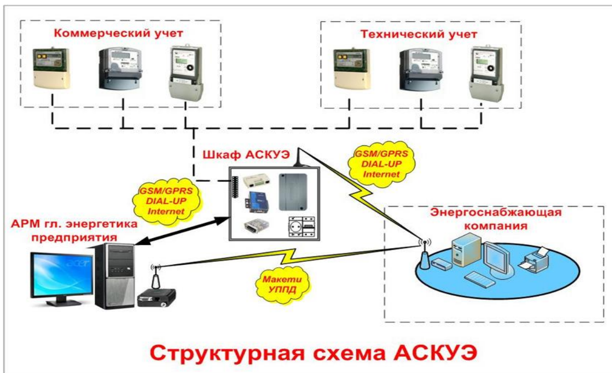
Рисунок 1 – Структурная схема системы АСКУЭ
