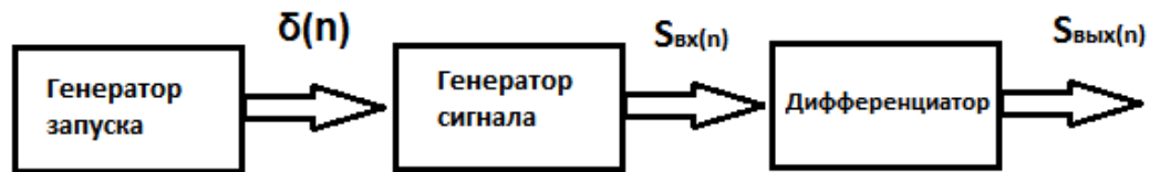
Рисунок 1 - Структурная схема исследования дифференцирования сигналов
