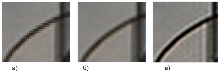
Рисунок 1 – Недостатки алгоритмов масштабирования: а) алиасинг, б) размытие, в) эффект Гиббса
