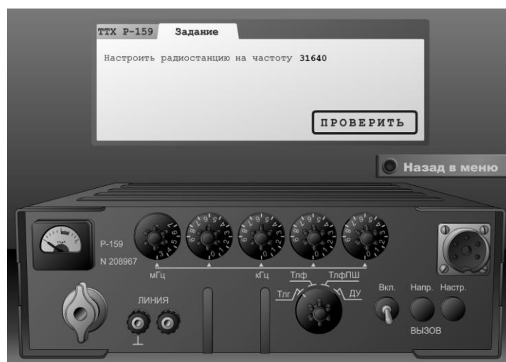
Рисунок 2. – Задание для настройки радиостанции P-159
