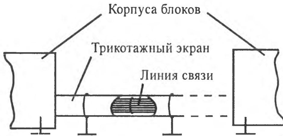
Рис. 8.9. Применение трикотажного полотна в качестве защитного электромагнитного экрана
