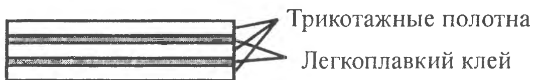
Рис. 8.5. Многослойная объемная трикотажная конструкция, полученная склеиванием отдельных полотен
