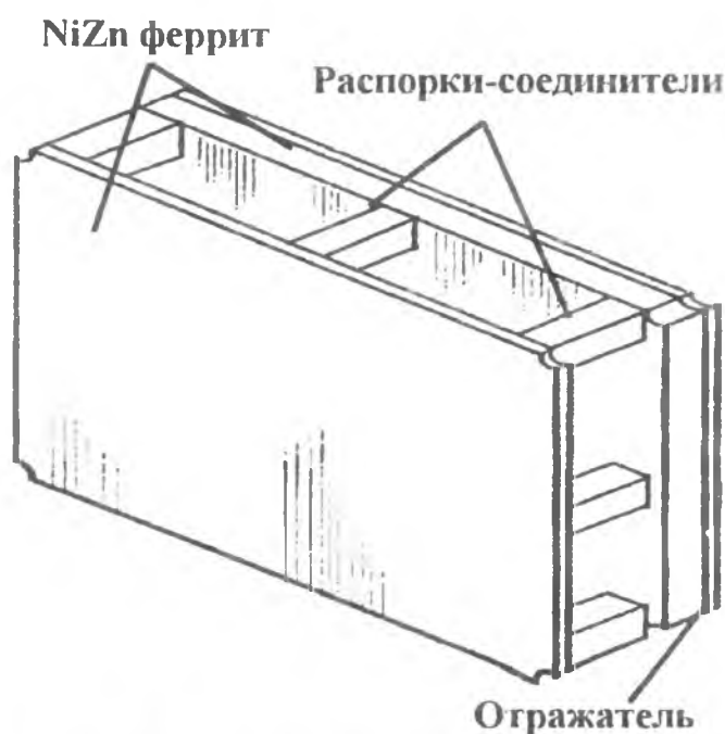
Рис. 4.9. Схема поглотителя ЭМИ
