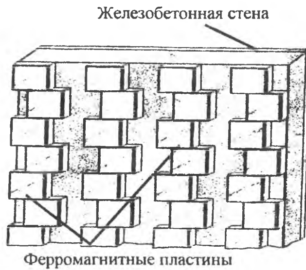
Рис. 4.39. Схема поглотителя отраженной радиоволны
