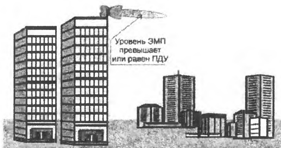
Рис. 1.12. Распределение энергии излучения антенны БС
