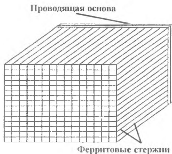
Рис. 4.12. Схема поглотителя ЭМИ на основе ферритовых стержней
