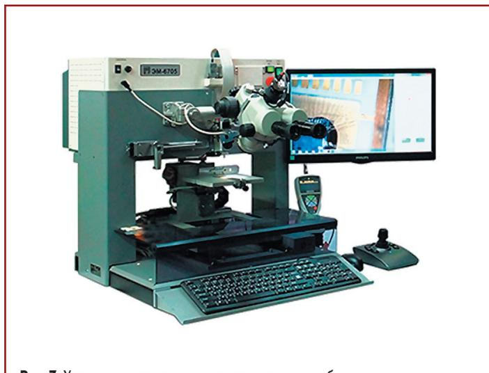
Рис. 7. Установка контроля прочности проволоочных и объемных выводов в интегральных схемах ЭМ-6705
