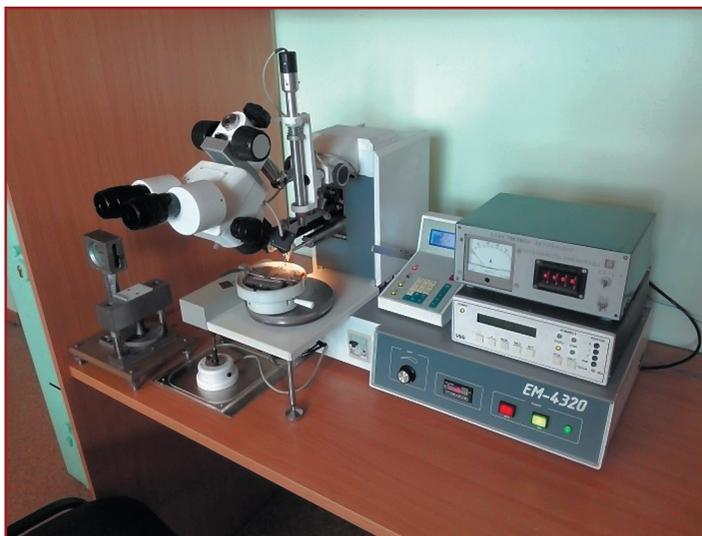
Рис. 6. Установка присоединения выводов ЭМ-4320 с блоком токовой активации
