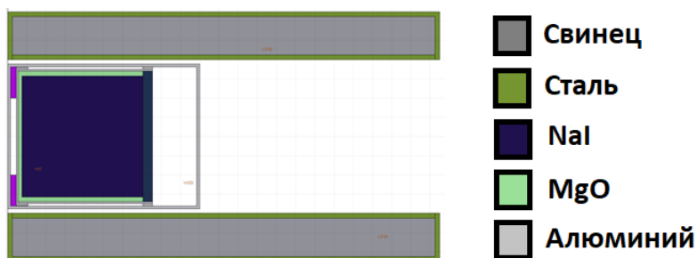
Рис. 1. Компьютерная Monte-Carlo модель блока детектирования СИЧ AT1322, состоящая из детектора, помещенного внутрь свинцового коллиматора
