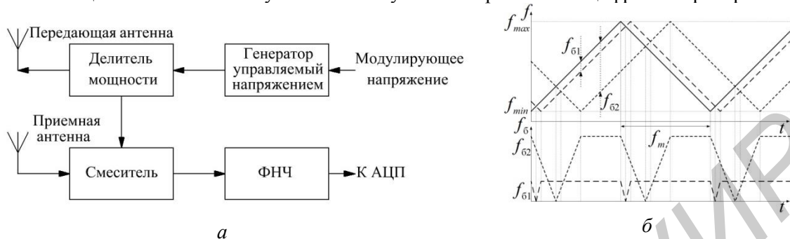
Рис. 1. Частотный метод измерения дальности: а – классическая структура радиолокатора; б – схема функционирования
