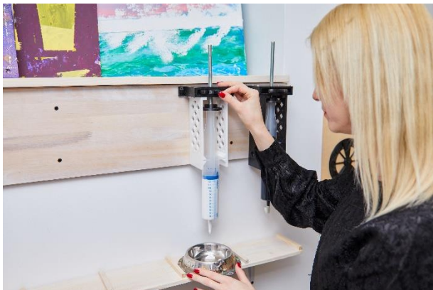
Рисунок 2 – Система дозирования краски
