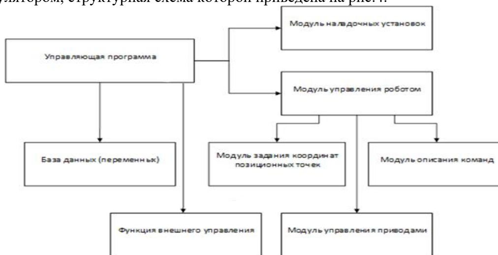
Рис. 4. Структурная схема управляющей программы
