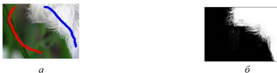
Рисунок 3. Пример работы алгоритма, основанного на обучении: а – исходное изображение с набросками: синий – передний план, красный – задний план; б – результат работы алгоритма
