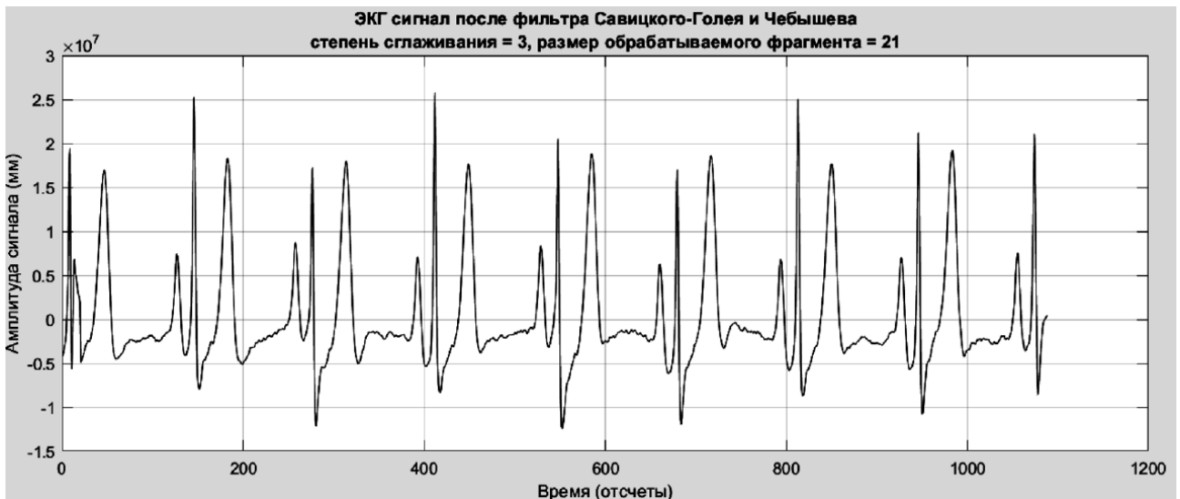
Рисунок 2 – Сигналы ЭКГ, сглаженные фильтрами Савицкого-Голея и Чебышева первого порядка
