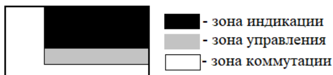
Рисунок 2 – Расположение функциональных зон электрокардиографа
