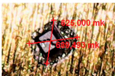
Рисунок 3 – Визуально-оптический контроль растекаемости припоя при монтаже кристалла
