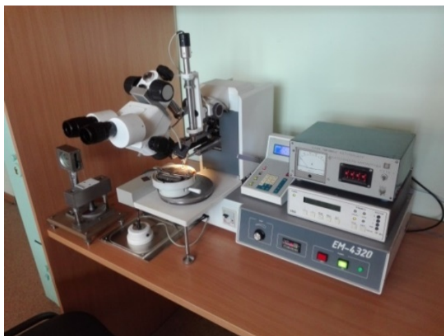
Рисунок 4 – Установка присоединения выводов ЭМ-4320
