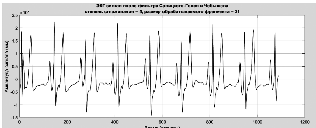
Рисунок 4 – Сигналы ЭКГ, сглаженные фильтром Савицкого-Голея пятого порядка и фильтром Чебышева первого порядка
