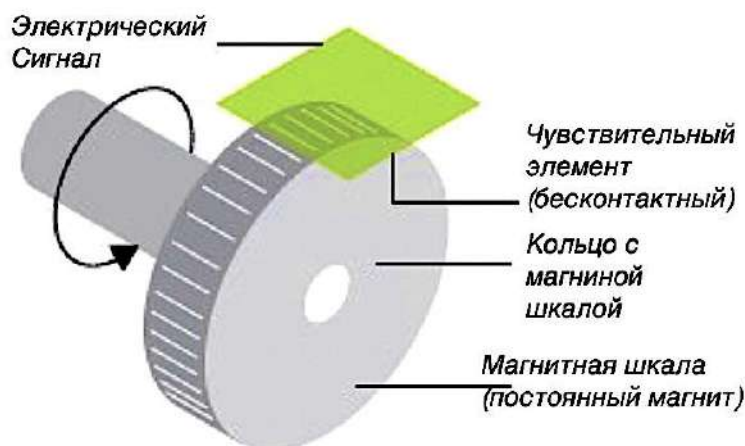
Рисунок 2 – Схема магнитного энкодера
