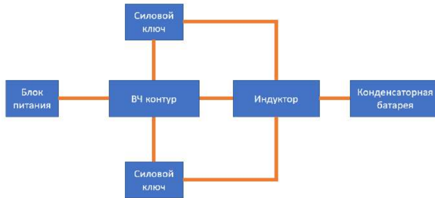
Рисунок 1 – Структурная схема ZVS генератора
