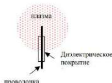
Рисунок 1 – Схема измерения СВЧ мощности активным зондом в плазме [2]
