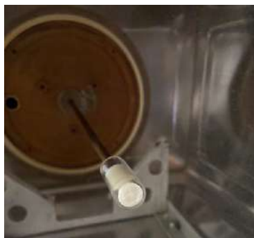
Рисунок 4 –Активный зонд, размещенный в СВЧ разрядной камере
